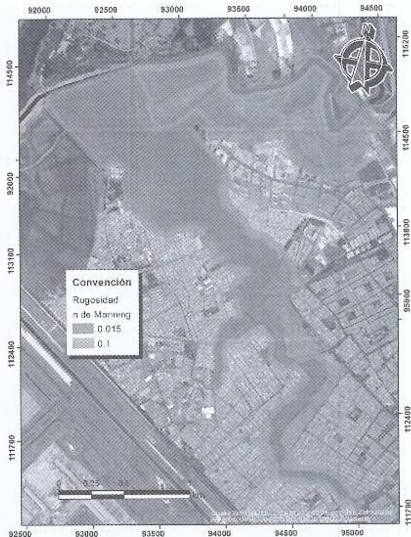
Figura 20. Coeficiente de rugosidad de Manning.
