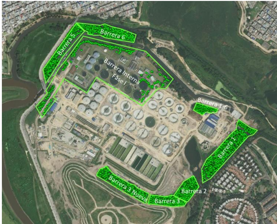
Imagen 5.1-1 Localización de las barreras ambientales en la PTAR Salitre
