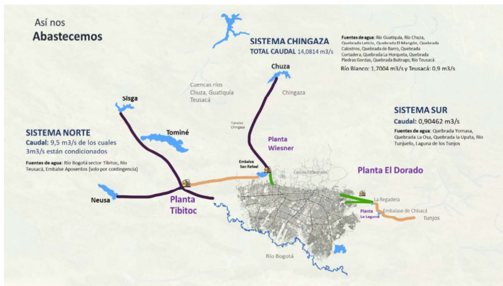
Figura No. 2. Sistema de tratamiento agua potable EAAB-ESP
