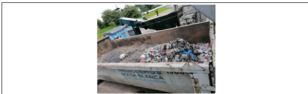
Fotografía 7. Residuos de pretratamiento provenientes del descargue de contenedores del material cribado resultante de grasa galerías y arenas
