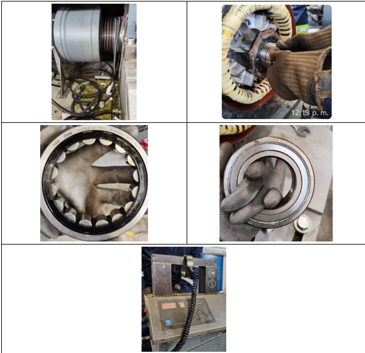
Fotografía 10. Mantenimiento motor del tornillo centrifuga 073SC002A
