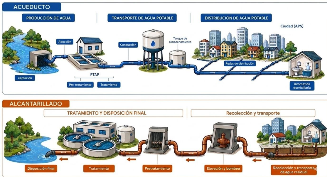
Ilustración 3 Diagrama de Subsistemas de Acueducto y Alcantarillado
